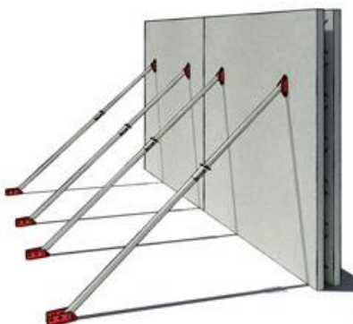
Etalement sur la Dalle
